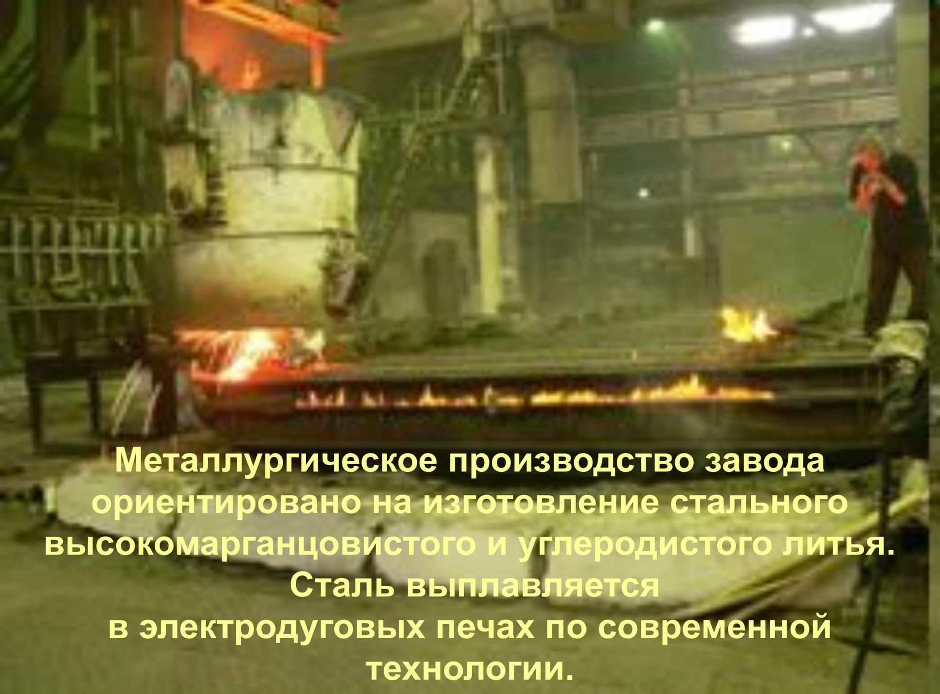
**Металлургическое производство завода ориентировано на изготовление стального высокомарганцовистого и углеродистого литья. Сталь выплавляется в электродуговых печах по современной технологии.**
