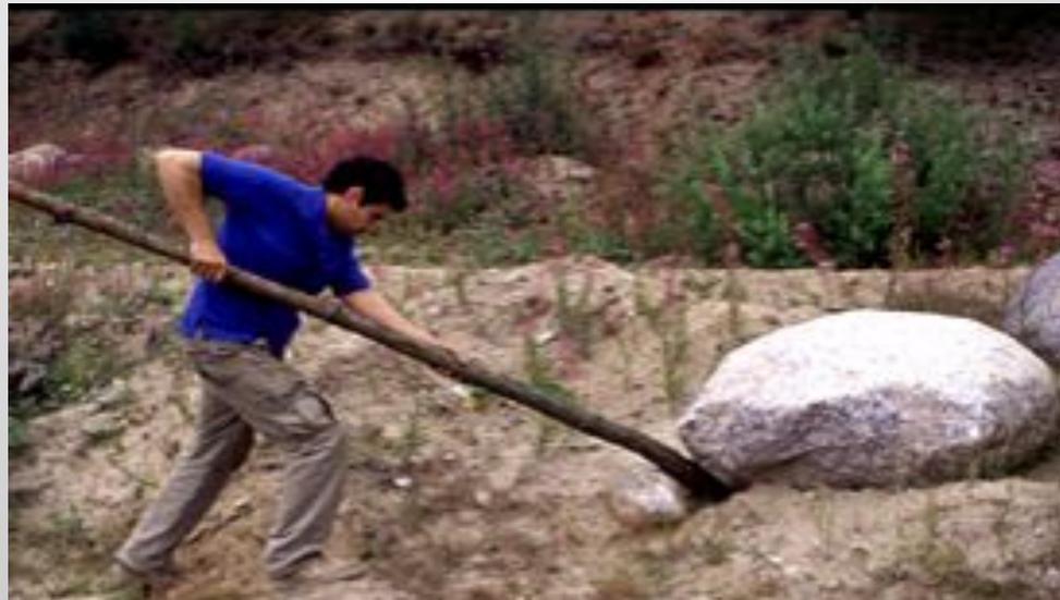
**Автомашину массой в несколько тонн шофер легко приподнимает при помощи домкрата. Домкрат — рычаг такого же типа, как лом, положенный на опору. Точки приложения сил (рука, автомобиль) лежат по обе стороны от точки опоры рычага домкрата. Здесь выигрыш в силе примерно в 40—50 раз, что дает возможность легко поднять огромную тяжесть.**
