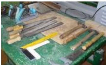
**вручную служит столярный инструмент (рубанок, рашпиль, напильник, киянка, уровень, молоток, фуганок, долото и т.д.)**
