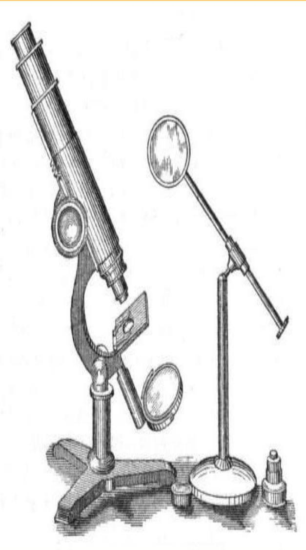
**МИКРОСКОП – оптический прибор с одной или несколькими линзами для получения увеличенных изображений объектов, не видимых невооруженным глазом. Микроскопы бывают простые и сложные.**
