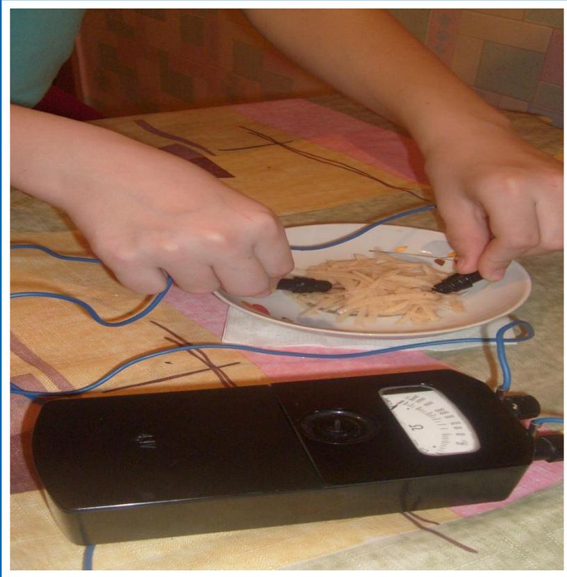
Фото 5. Измеряем сопротивление сердцевинки картофеля.
