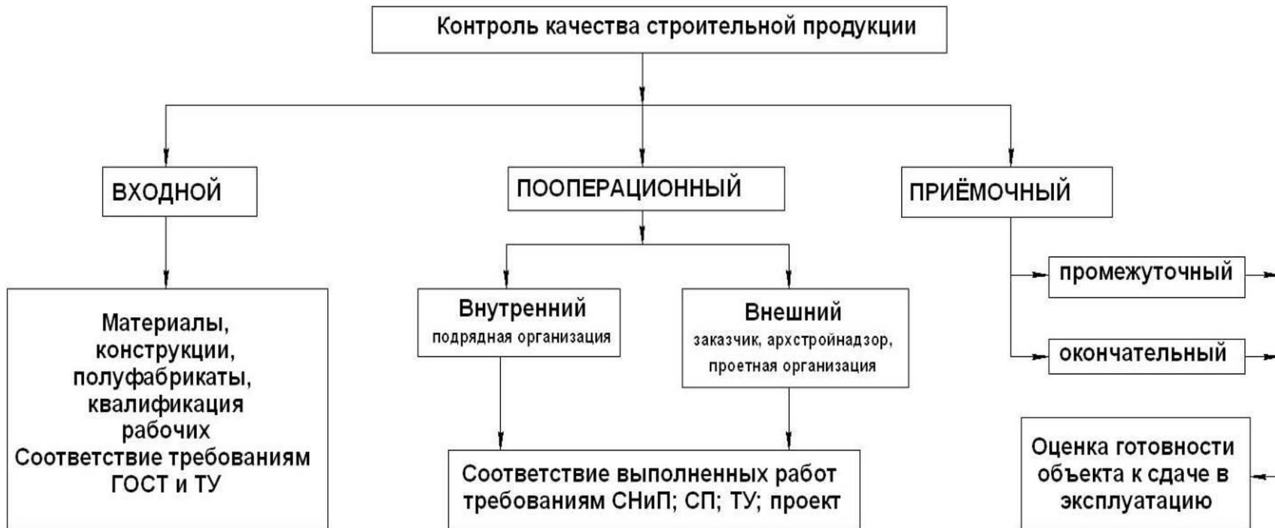
Рис. 1.3 Схема контроля качества строительной продукции
