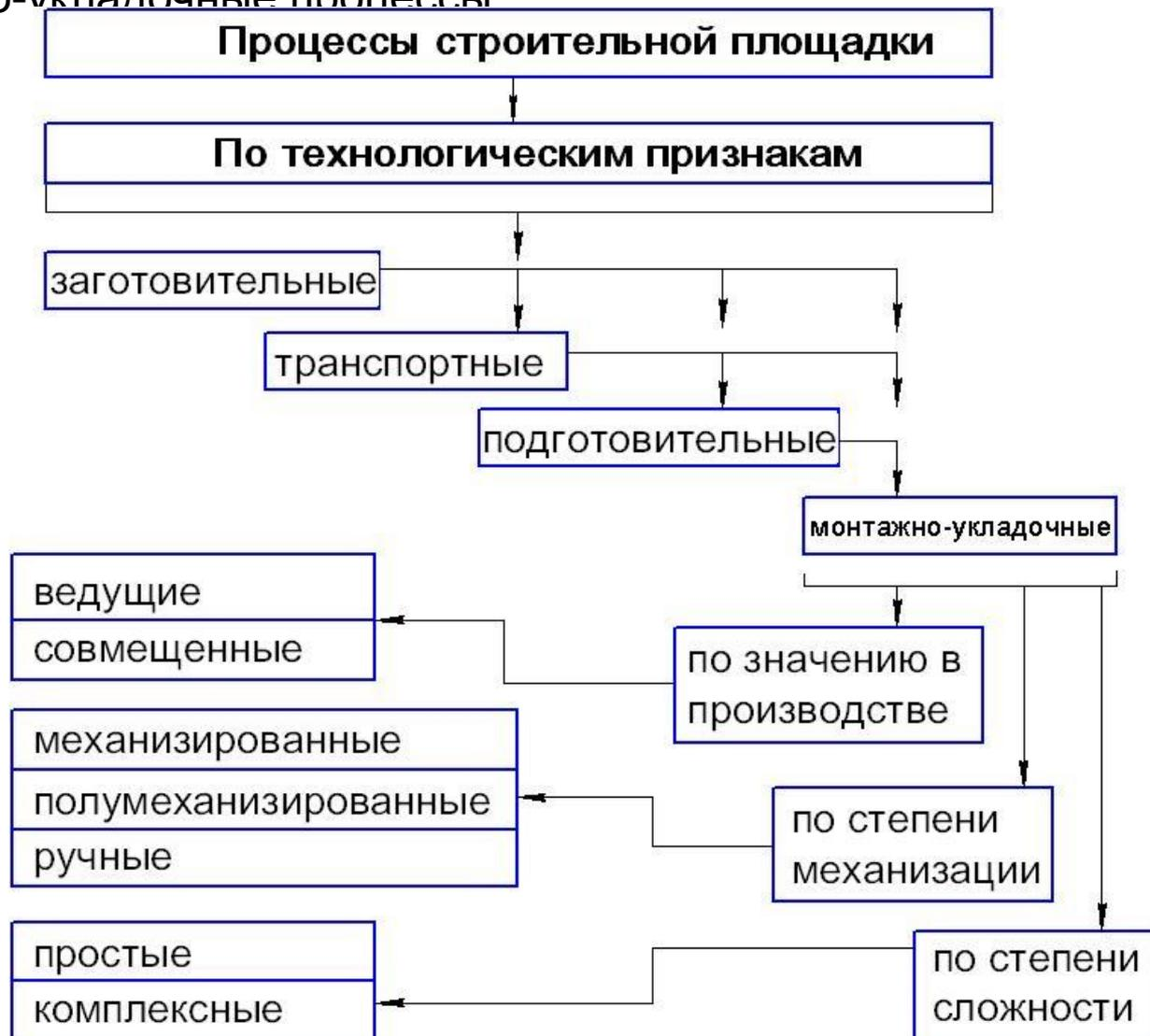
**Рис.1.1** Схема классификации строительных процессов
