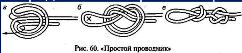
Рис. 60. «Простой проводник»
