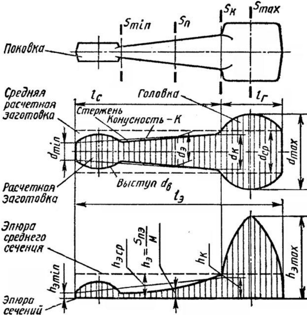
Рисунок 9.2 – Элементарная расчетная заготовка и ее эпюра сечений
