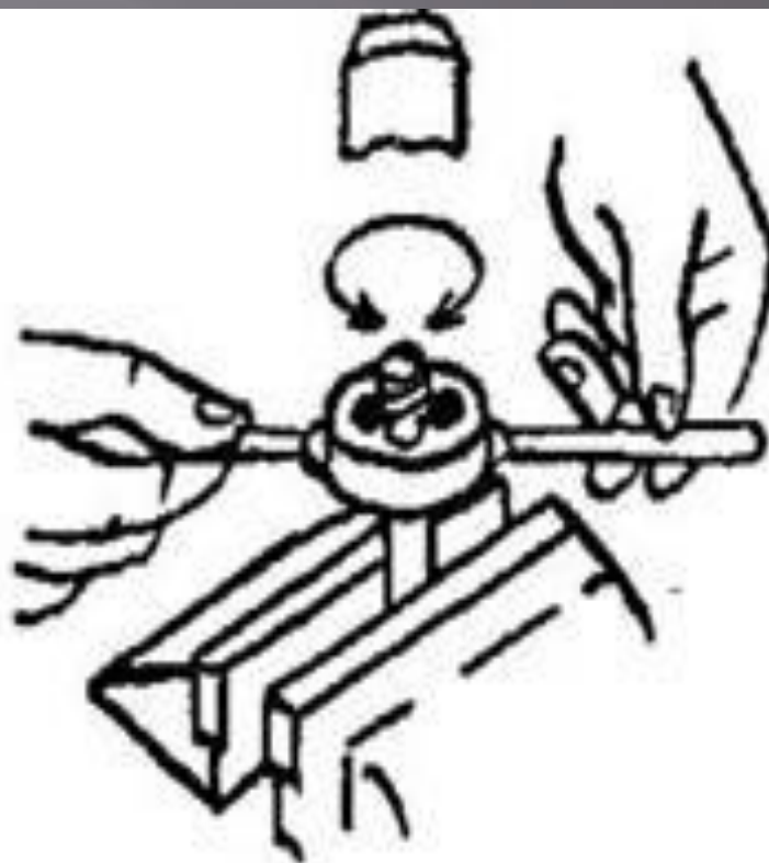
Рис. 54. Нарезание наружной резьбы.
