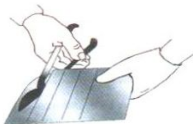
Резание ручными ножницами
