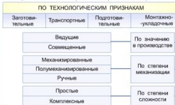
Классификационная схема процессов строительного производства
