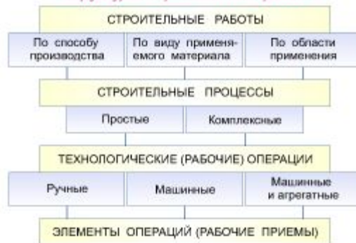
Классификационная схема процессов строительного производства
