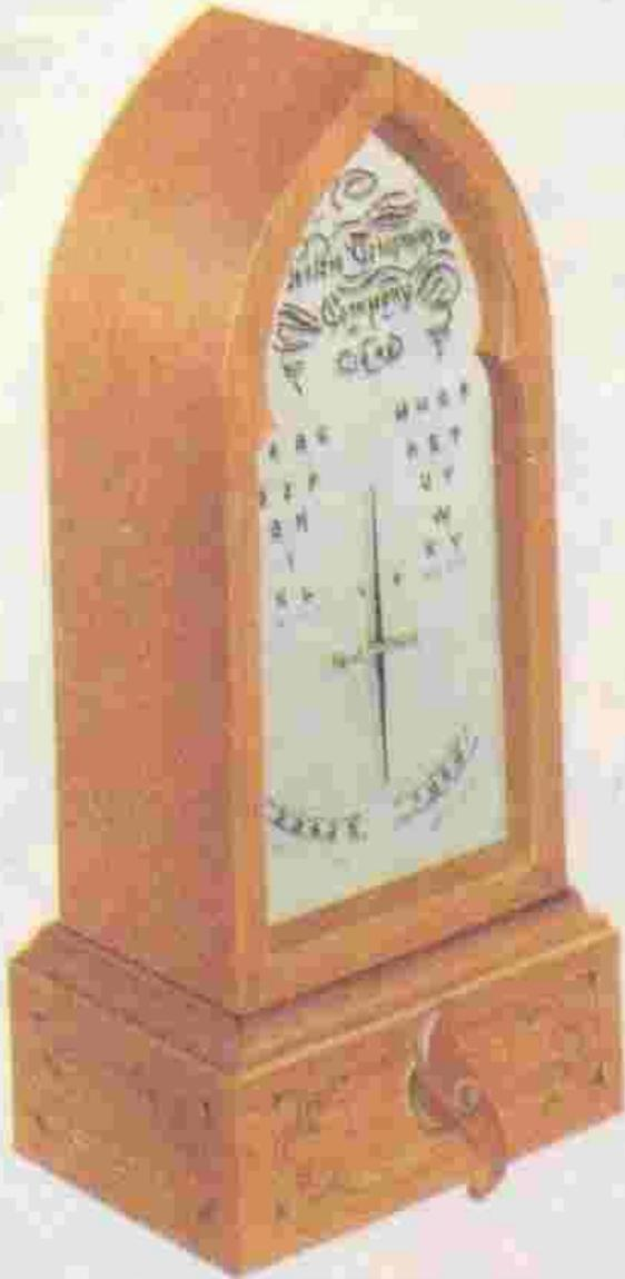
Сигналы приводили в действие стрелки на приемнике, которые указывали на разные буквы и таким образом передавали сообщение.
