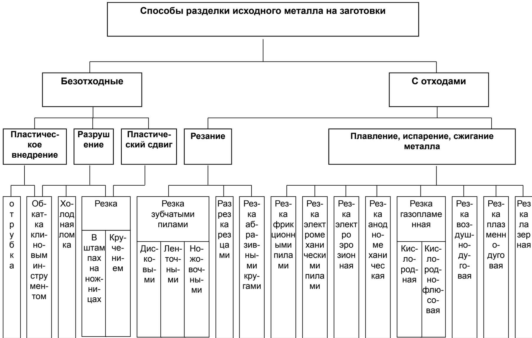
**Рисунок 6.2** – Классификация способов разделки исходного металла на заготовки
