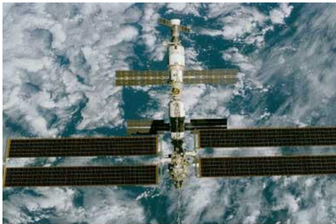
Солнечные батареи на Международной космической станции
