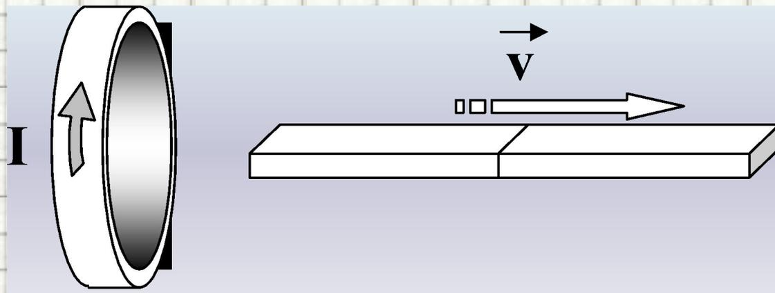
**A19.** На рисунке приведена демонстрация опыта по проверке правила Ленца. Опыт проводится со сплошным кольцом, а не разрезанным,
