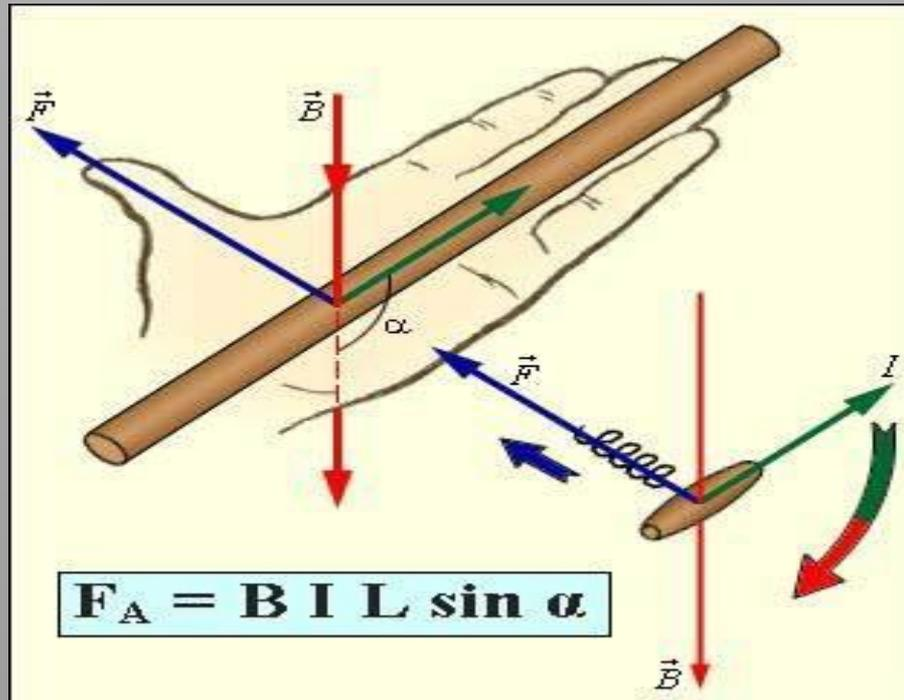
Если левую руку расположить так, чтобы вектор магнитной индукции входил в ладонь, а вытянутые четыре пальца были направлены вдоль тока, то отведенный на  $90^\circ$  большой палец укажет направление действия силы Ампера.
