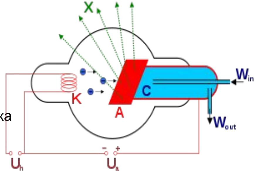
X — рентгеновские лучи, K — катод X — рентгеновские лучи, K — катод, A — анод (иногда называемый антикатодом), C — теплоотвод,  $U_h$  — напряжение накала катода,  $U_a$  — ускоряющее напряжение,  $W_{in}$  — впуск водяного охлаждения,  $W_{out}$  — выпуск водяного охлаждения.
