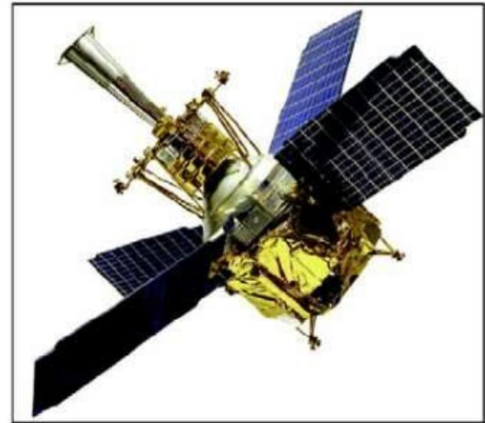
Спутник, запущенный в рамках проекта GPB. Все экспериментальное оборудование заключено в большой контейнер с жидким гелием.
