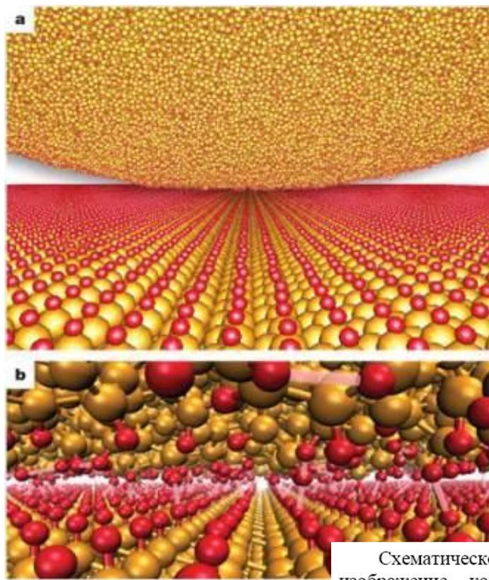
Схематическое изображение контакта между сферой из углерода и поверхностью алмаза, поверхность которого пассивирована водородом: *a* - общий вид, желтые атомы — углерод, красные — водород; *b* - сечение контактирующих поверхностей: показаны ковалентные связи между молекулами, а также силы отталкивания (обозначены розовым); *c* - контактирующие атомы (серые шестиугольники) и контур микрошероховатости [1].
