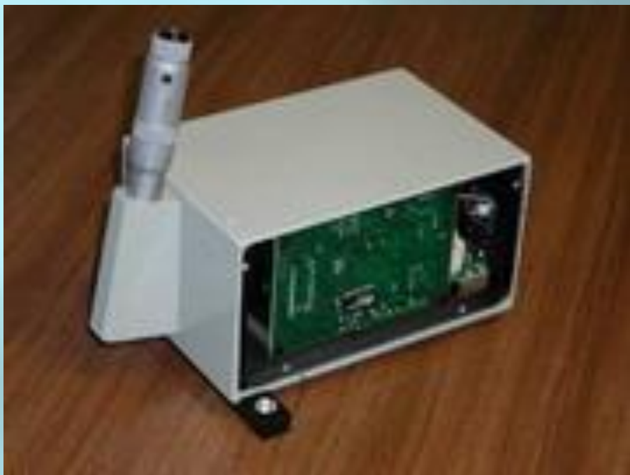
СПЕКТРОГРАФ MC-75 С СИСТЕМОЙ РЕГИСТРАЦИИ НА ШИНУ USB.
