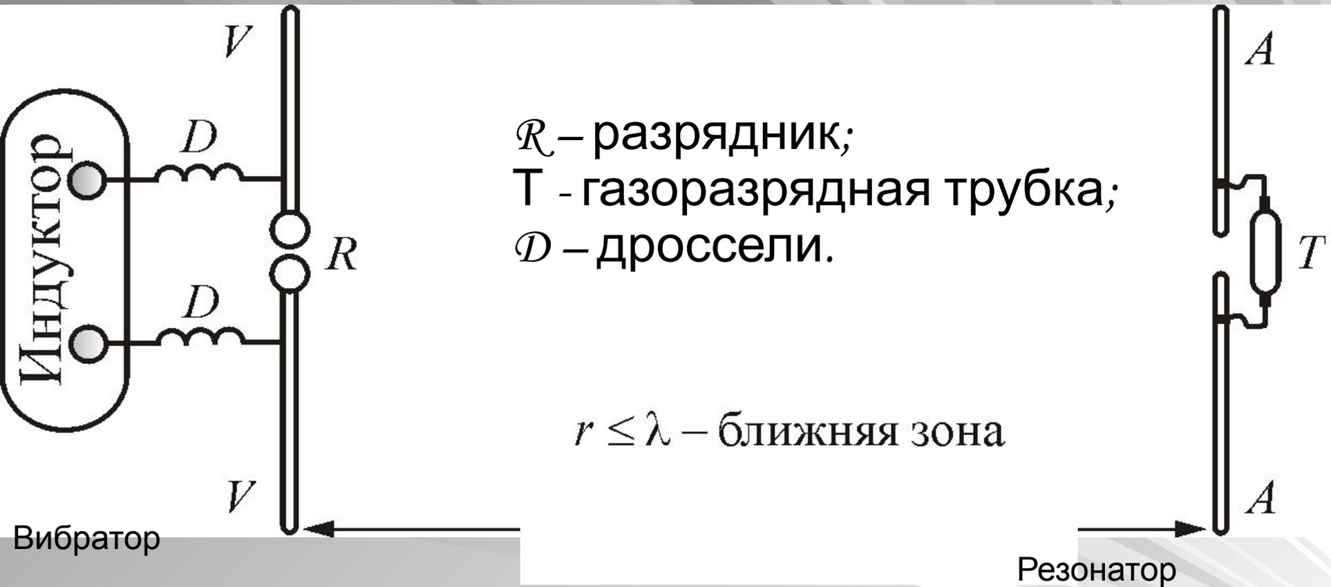
Движущийся с ускорением электрический заряд испускает электромагнитные волны.
