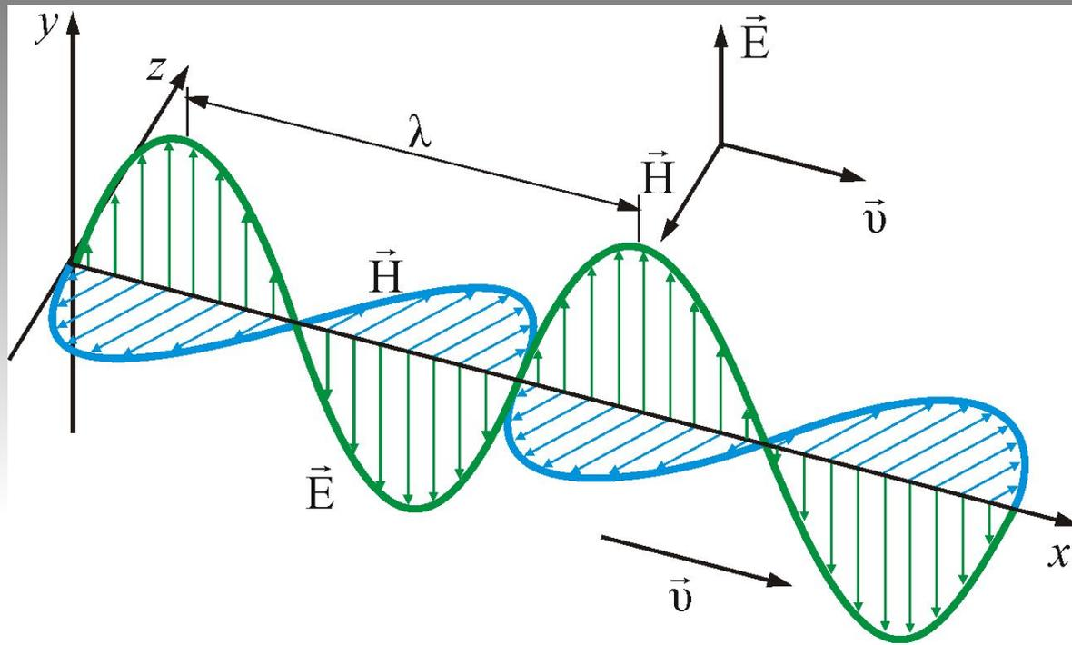
Поля изменяют свое направление в пространстве: в одних точках вектор  $\mathbf{H}$  направлен к плоскости страницы, в других – от нее; аналогично ведет себя и вектор  $\mathbf{E}$ . Электрическое и магнитное поля находятся в фазе, т.е. они достигают максимума и обращаются в нуль в одних и тех же точках.
