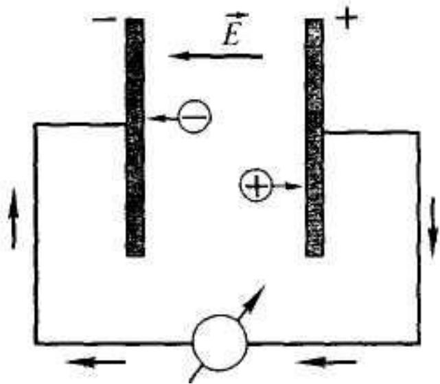
На рисунке показана принципиальная схема гальванического элемента: в нем под действием поля сторонних сил положительные заряды внутри источника тока движутся против сил электростатического поля и собираются у положительного полюса, а отрицательные заряды собираются у противоположного полюса — отрицательного. На концах цепи за счет работы сторонних сил будет поддерживаться постоянная разность потенциалов.
