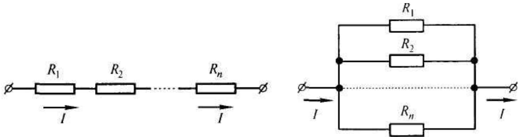
При *последовательном соединении*  $n$  проводников конец первого проводника соединяют с началом второго и т. д
