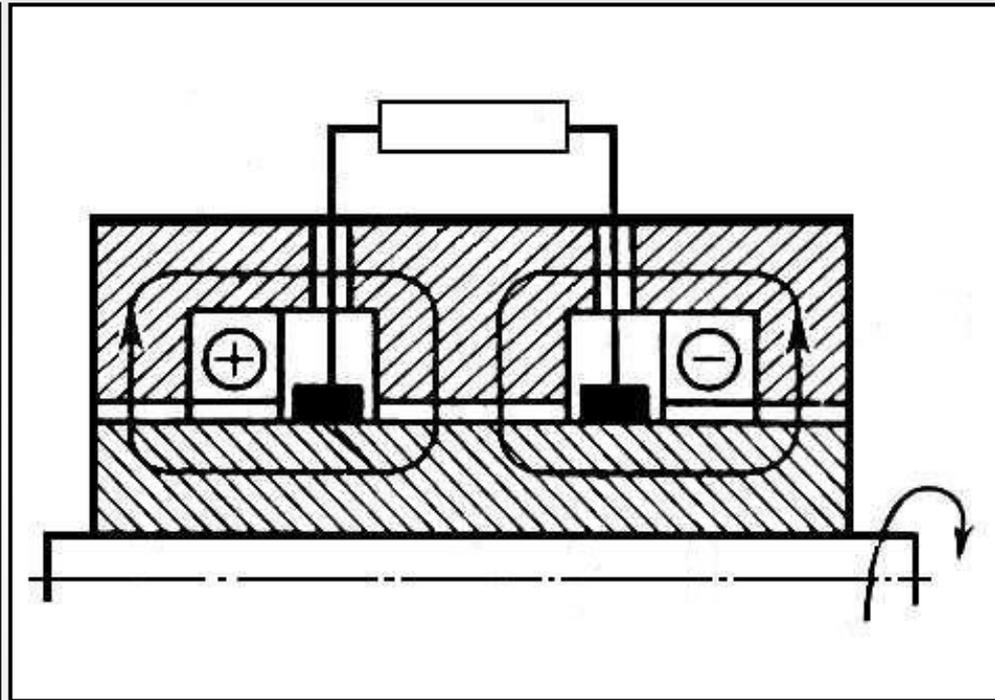
При вращении проводящего диска в постоянном магнитном поле за счет действия силы Лоренца на движущиеся электроны происходит разделение электрического заряда, приводящее к возникновению разности потенциалов между центром и краем диска.
