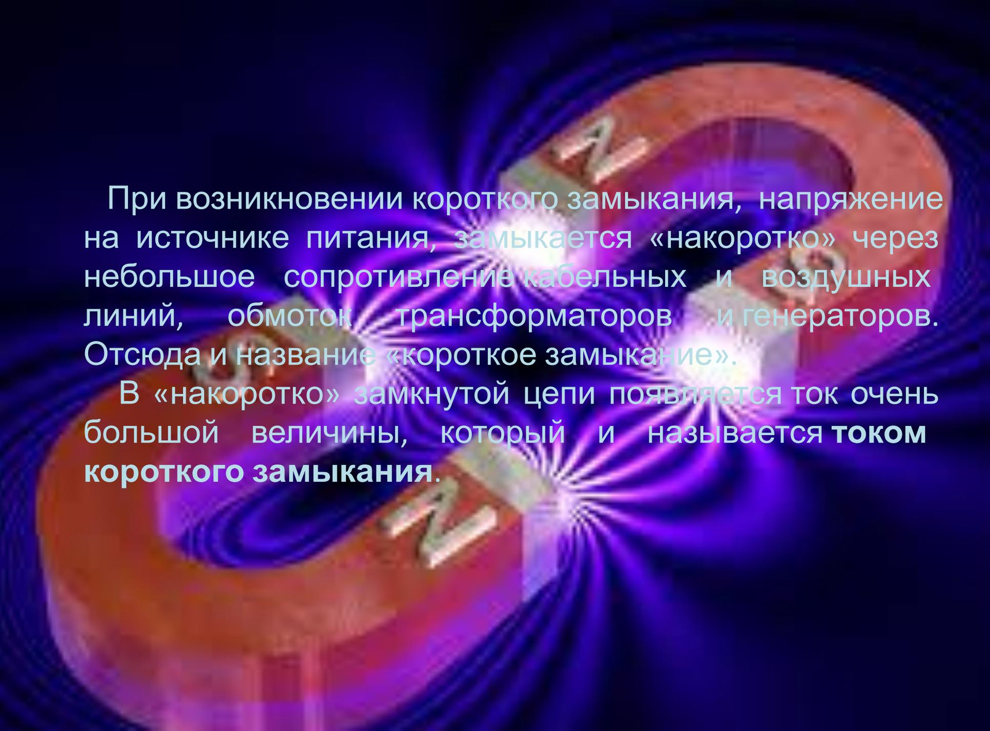
При возникновении короткого замыкания, напряжение на источнике питания, замыкается «накоротко» через небольшое сопротивление кабельных и воздушных линий, обмоток трансформаторов и генераторов. Отсюда и название «короткое замыкание».
