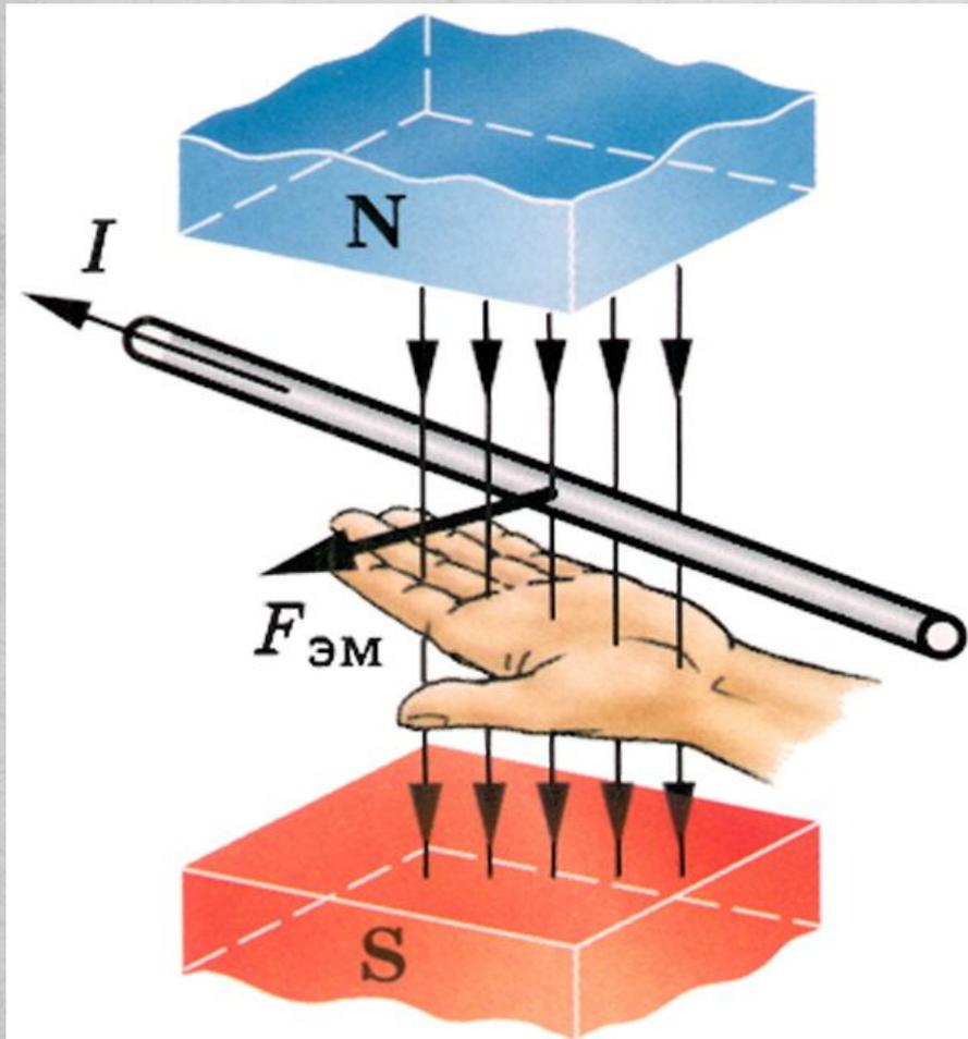
Если левую руку расположить так, чтобы вектор магнитной индукции входил в ладонь, а вытянутые четыре пальца были направлены вдоль тока, то отведенный на  $90^\circ$  большой палец укажет направление действия силы Ампера.
