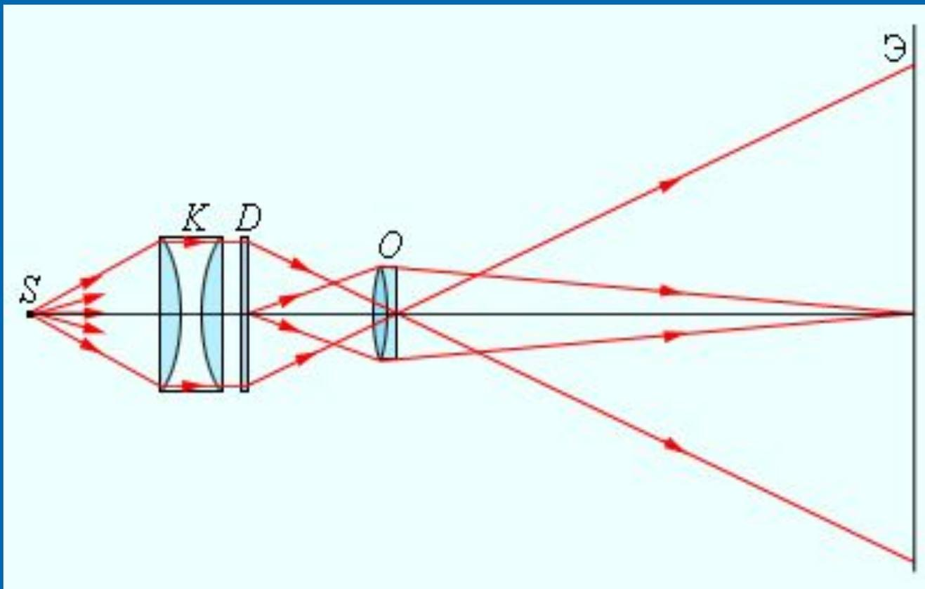
Проекционный аппарат предназначен для увеличения изображения, нанесенного на прозрачную основу. Источник света освещает пластинку с изображением. Проходя через нее, лучи света преломляются в системе линз, из которой выходят расходящимся пучком.
