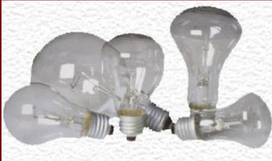
Лампы накаливания общего назначения. Применяются уже более ста лет и являются на сегодняшний день самыми распространенными и насчитывают множество типов - это обычные лампы, декоративные, цветные и зеркальные лампы. Лампы используются в сетях переменного тока напряжением 127 и 220 В и частотой 50 Гц. Выпускают лампы вакуумные с аргоновым и криптоновым наполнителем. Средняя продолжительность горения составляет 1000 часов.
