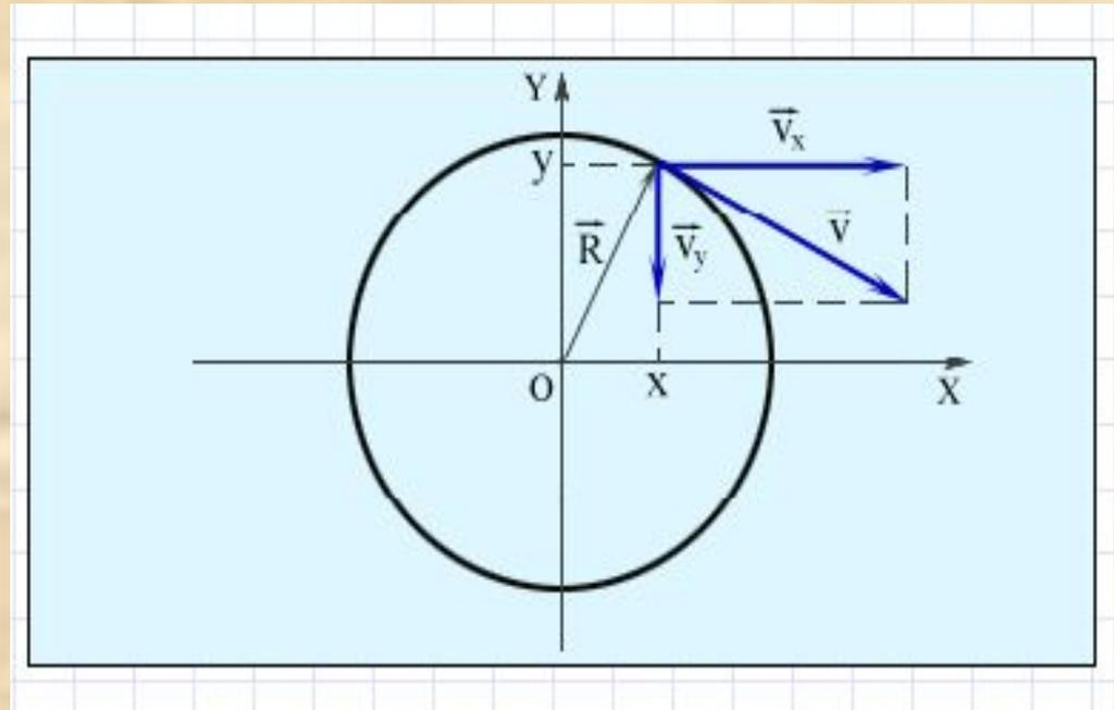
**Разложение вектора скорости по координатным осям.**
