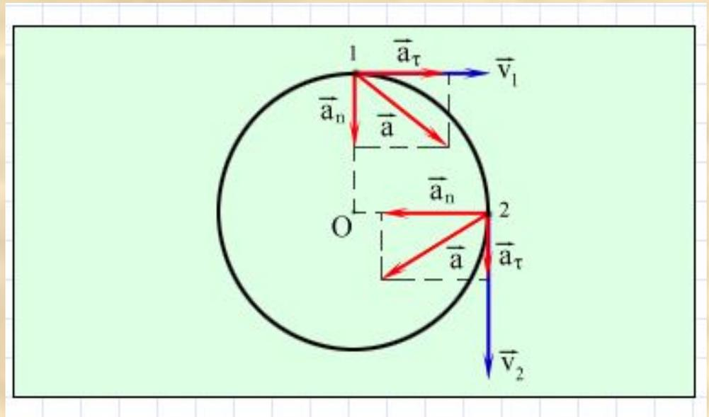
**Ускорение тела при неравномерном движении по окружности.**
