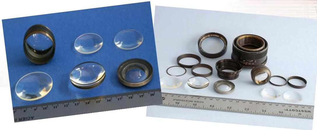
*Линзой* называется прозрачное тело, ограниченное двумя криволинейными (чаще всего сферическими) или криволинейной и плоской поверхностями.
