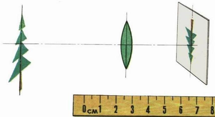
Рисунок в схематическом виде перенесите в тетрадь с соблюдением масштаба. Используя графический метод, определите оптическую силу линзы. Выполните необходимые построения хода лучей.
