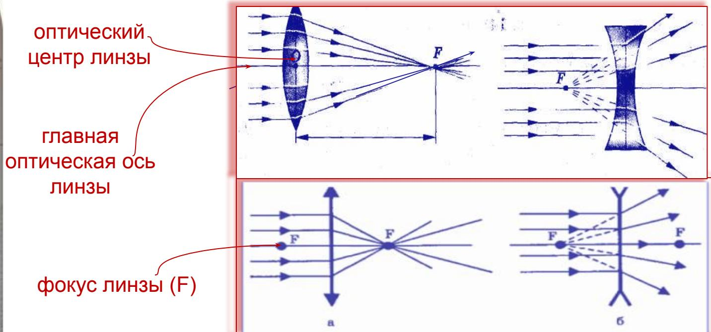
В фокусе рассеивающей линзы пересекаются продолжения лучей, которые до преломления были параллельны ее главной оптической оси. Фокус рассеивающей линзы мнимый. Главных фокусов два; они расположены на главной оптической оси на одинаковом расстоянии от оптического центра линзы по разные стороны от нее.
