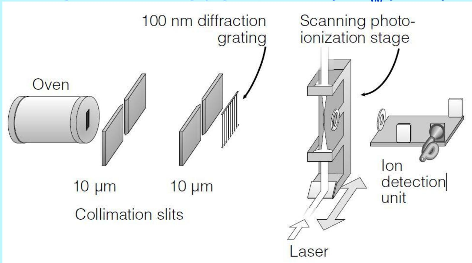
Чтобы сформировать пучок, молекулы  $C_{60}$  (**фуллерена!!!!**) проходят через два коллиматора шириной  $10\mu\text{m}$  каждый и расстояние между которыми составляет  $1,04$  м. За вторым коллиматором находится дифракционная решетка с периодом  $d=100\text{nm}$ . На расстоянии  $L=1,25$  м от нее находится детектор атомов  $C_{60}$ .
