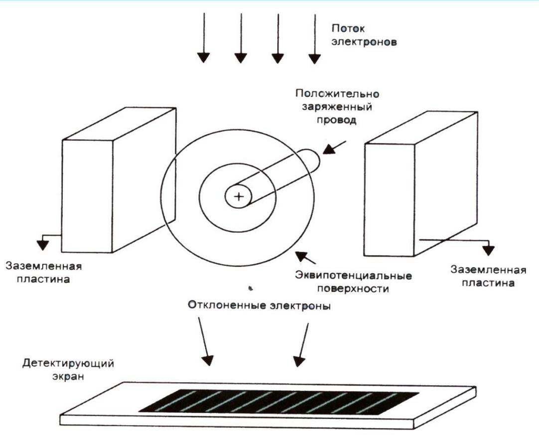
Для создания аналога двух щелей использовалась двойная электронная призма: электроны, ускоренные до 50 КэВ, проходили между двумя заземленными пластинами и отклонялись тонким проводом с положительным потенциалом, расположенным между ними.
