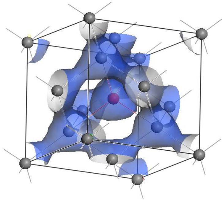
Распределение электронной плотности в элементарной ячейке алмаза и в ячейке содержащей тетраэдрический междуузельный атом углерода.
