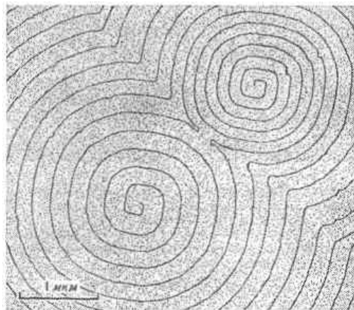
Скопление дислокаций на межзеренных границах
