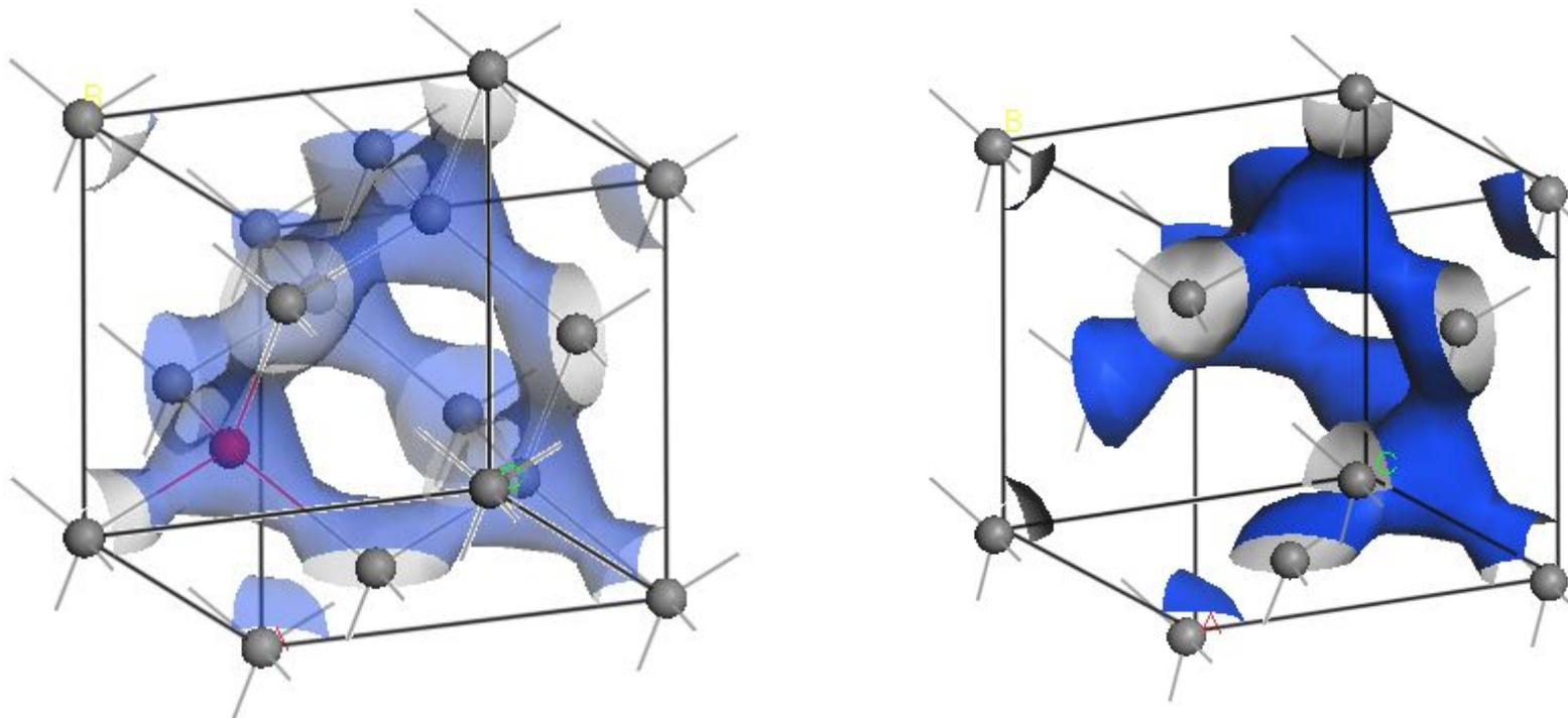
Распределение электронной плотности в идеальной элементарной ячейке алмаза и в ячейке содержащей одиночную вакансию.
