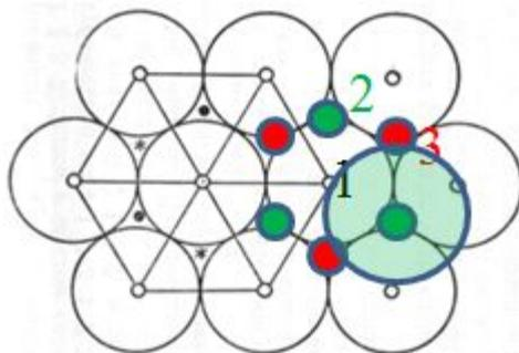
Расположение атомов в плотноупакованных кристаллических решетках. Светлые кружки- положения типа 1; Черные кружки – положения типа 2; Звездочки – положения типа- 3.
