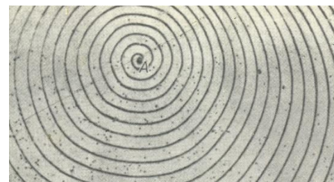
Винтовая дислокация роста кристалла.
