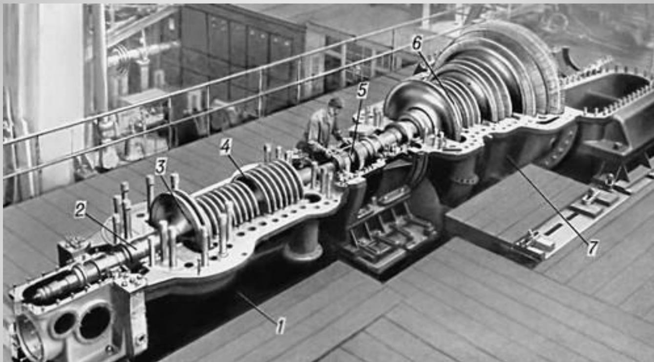
Двухкорпусная паровая турбина (со снятыми крышками):
