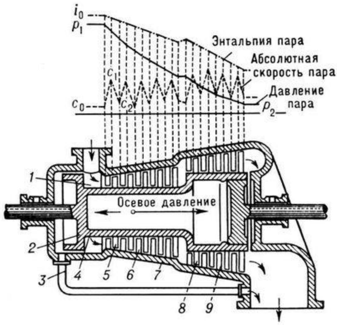
Схематический разрез небольшой реактивной турбины: 1 — кольцевая камера свежего пара; 2 — разгрузочный поршень; 3 — соединительный паропровод; 4 — барабан ротора; 5, 8 — рабочие лопатки; 6, 9 — направляющие лопатки; 7 — корпус
