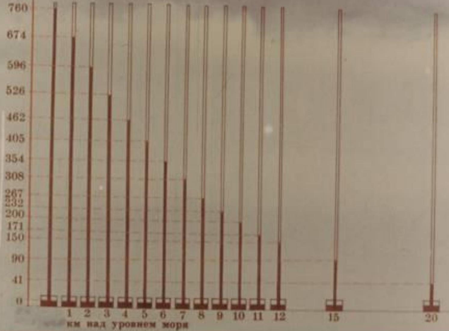
На небольших высотах каждые 12 м подъёма уменьшают атмосферное давление на 11 мм рт. ст. На больших высотах эта закономерность нарушается.
