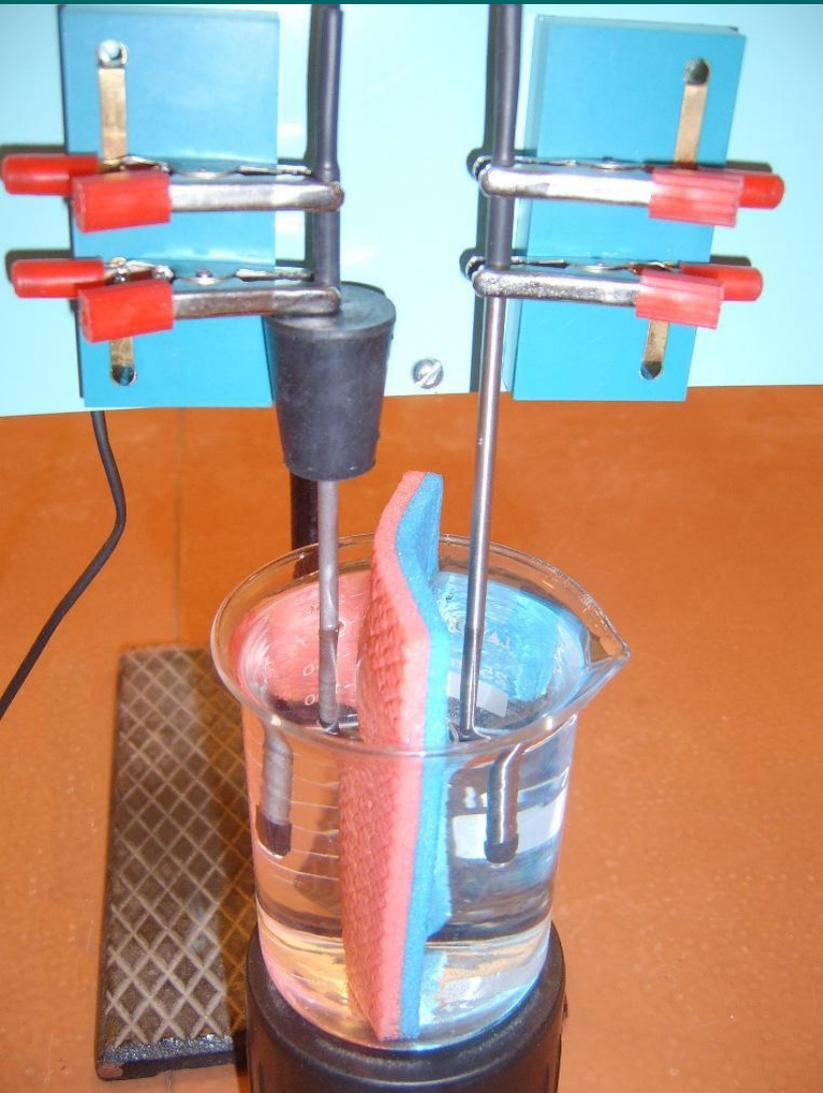
«Наблюдение конвекции при смешивании горячей и холодной воды, разделённой до этого перегородкой».
