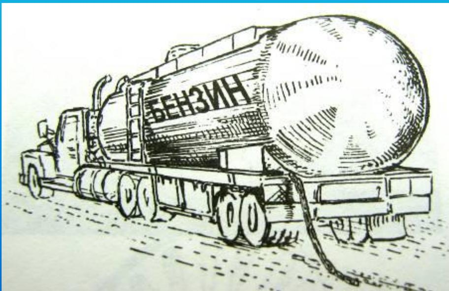
Зачем к цистерне прикрепляют металлическую цепь, которая касается земли?
