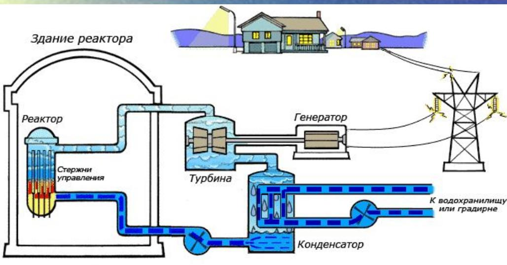
При делении ядер урана образуются быстрые нейтроны. Через теплоноситель При делении ядер урана образуются быстрые нейтроны. Через теплоноситель энергия поступает в парогенератор. Пар высокого давления направляется в турбогенераторы При делении ядер урана образуются быстрые нейтроны. Через теплоноситель энергия поступает в парогенератор. Пар высокого давления направляется в турбогенераторы.
