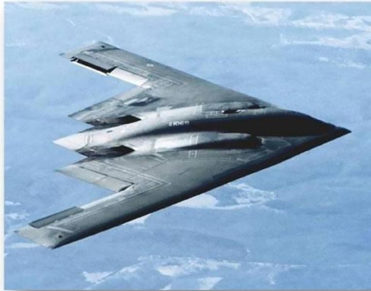
**«Стелс»-технология уменьшает вероятность того, что самолет будет запеленгован противником. Поверхность самолёта собрана из нескольких тысяч плоских треугольников, выполненных из материала, хорошо поглощающего радиоволны. Луч локатора, падающий на нее, рассеивается, т.е. отражённый сигнал не возвращается в точку, откуда он пришёл (к радиолокационной станции противника).**
