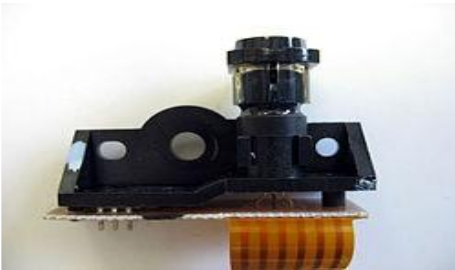
Полупроводниковый лазер , применяемый в узле генерации изображения принтера Hewlett-Packard
