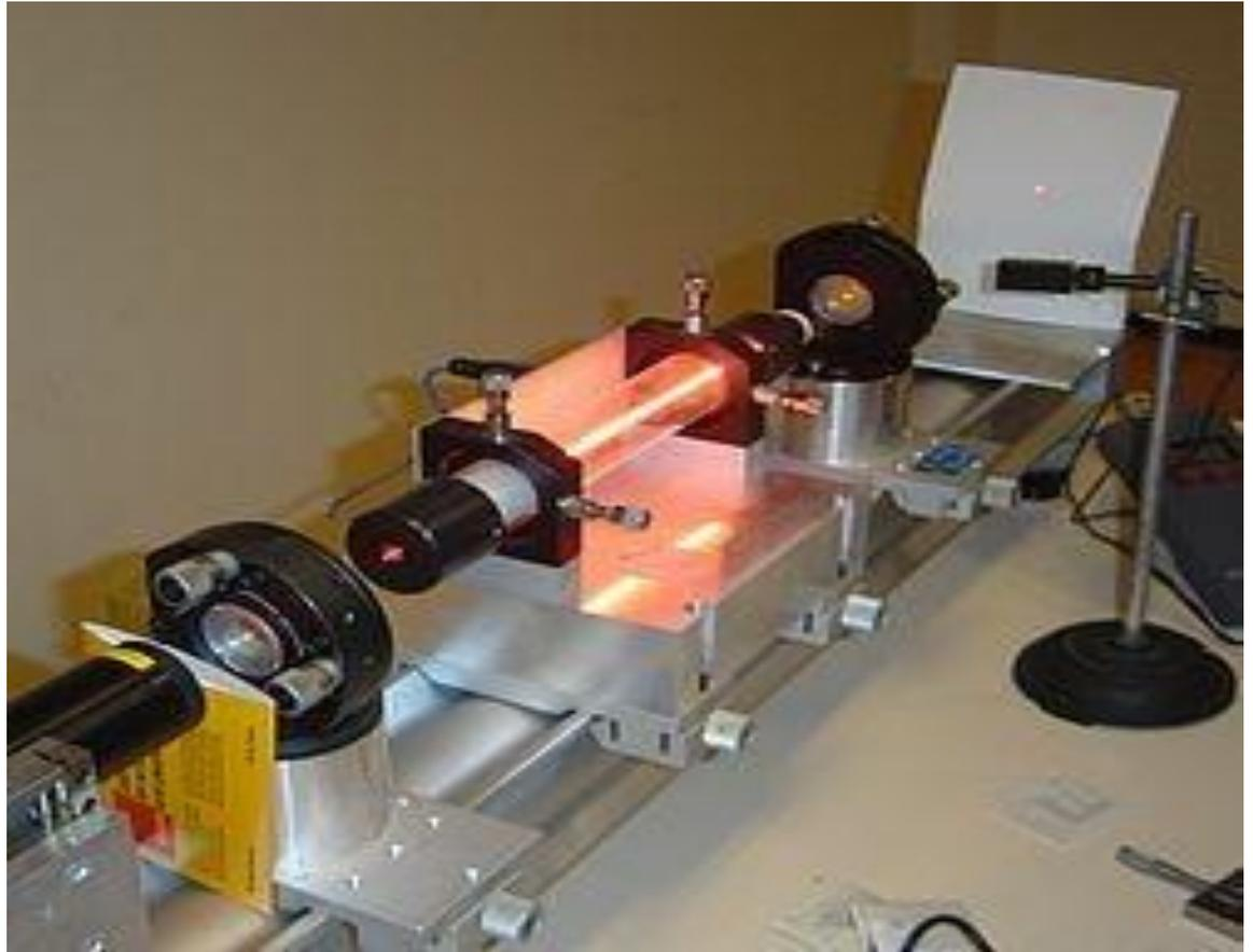
лабораторных опытах Гелий-неоновый лазер. Светящийся луч в центре — это не собственно лазерный луч, а электрический разряд гелий-неоновый лазер. Светящийся луч в центре — это не собственно лазерный активная средой электрический разряд, порождающий свечение, подобно тому, как которого является в смеси газовых лампах. Луч проецируется на экран справа в
