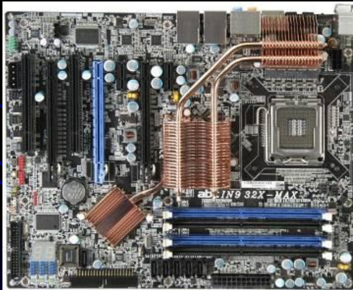
Полимерные конденсаторы с твёрдым электролитом на чипсете
