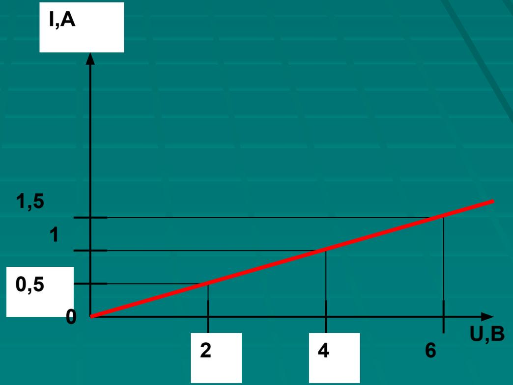
Сила тока в проводнике прямо пропорциональна напряжению на концах проводника.
