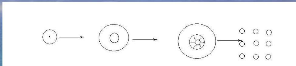
Схема разрушения оксидной пленки.
