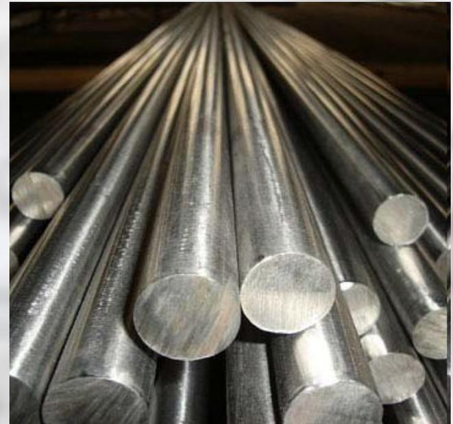
По химическому составу стали делятся на углеродистые и легированные; в том числе по содержанию углерода — на низкоуглеродистые (до 0,25 % C), среднеуглеродистые (0,3—0,55 % C) и высокоуглеродистые (0,6—2 % C)
