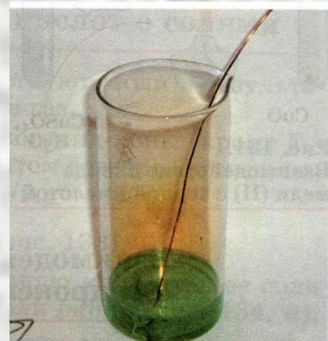
Взаимодействие кон.  $\text{HNO}_3$  с медью сопровождается образованием бурого газа – **оксида азота (IV)**
