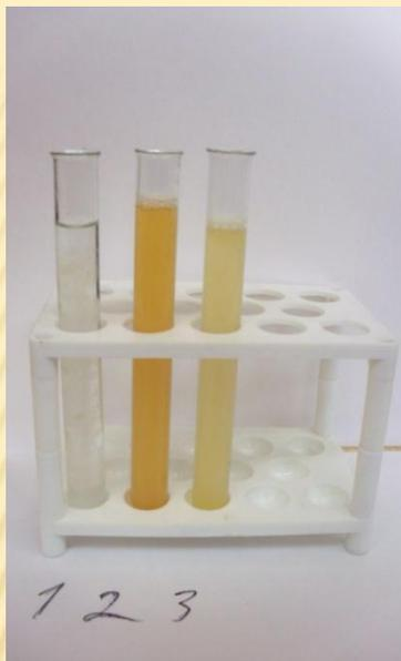
**Ход работы:** Выжимаем сок из апельсина, банана и мандарина. Наливаем соки в шесть пробирок. Контрольная группа – 3 пробирки. Экспериментальная группа – 3 пробирки. Приливаем к экспериментальной группе  $\text{CuSO}_4$  и  $\text{NaOH}$ . Ставим эту группу на водяную баню. Сравниваем две группы.
