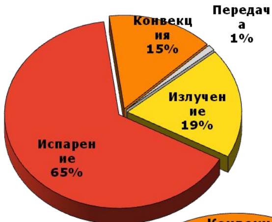
Теплообмен без системы охлаждения
