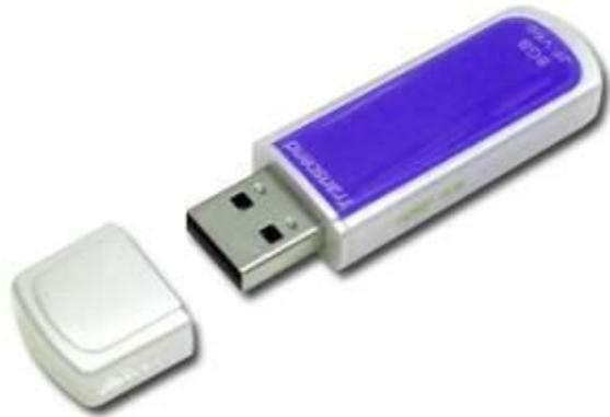
Бит сохраняется за счет использования **транзистора с двумя изолированными затворами.**
