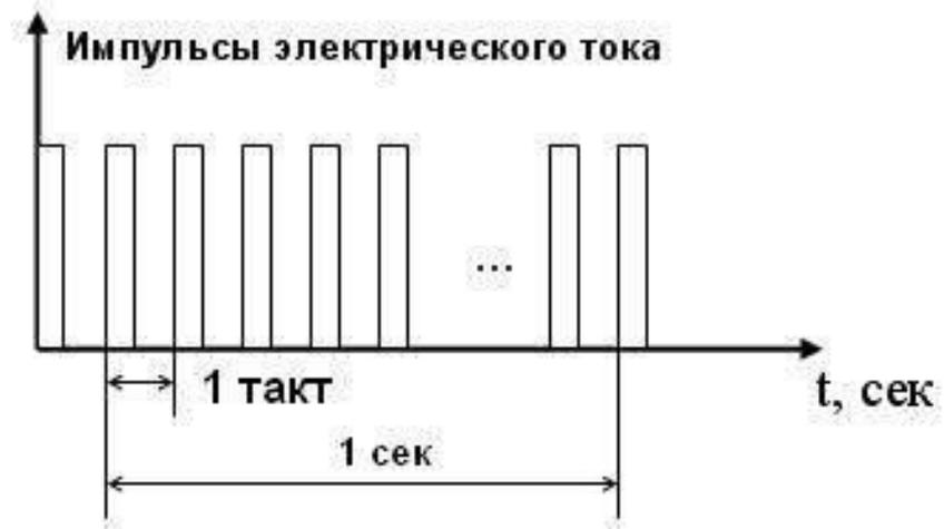
Тактовые колебания образуются в **тактовом генераторе** (микросхеме) основу которой составляет кристалла кварца, находящийся в специальном контейнере.
