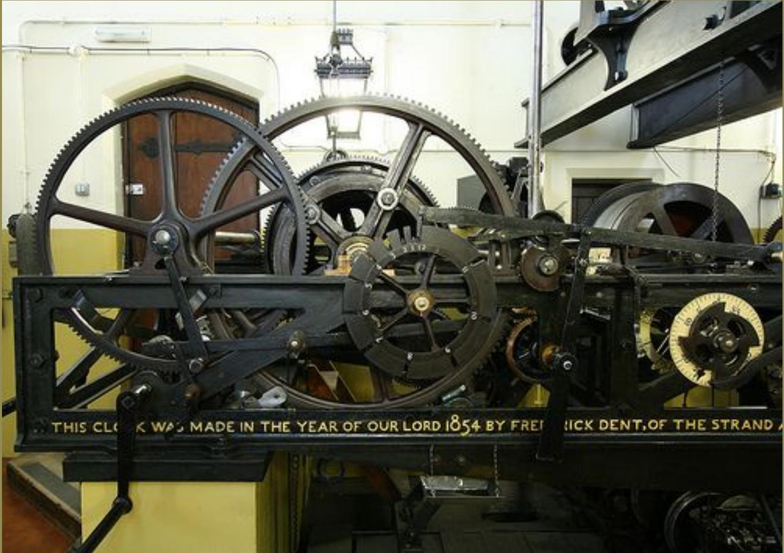
Механизм, приводящий в действие молот колокола Биг-Бен.
