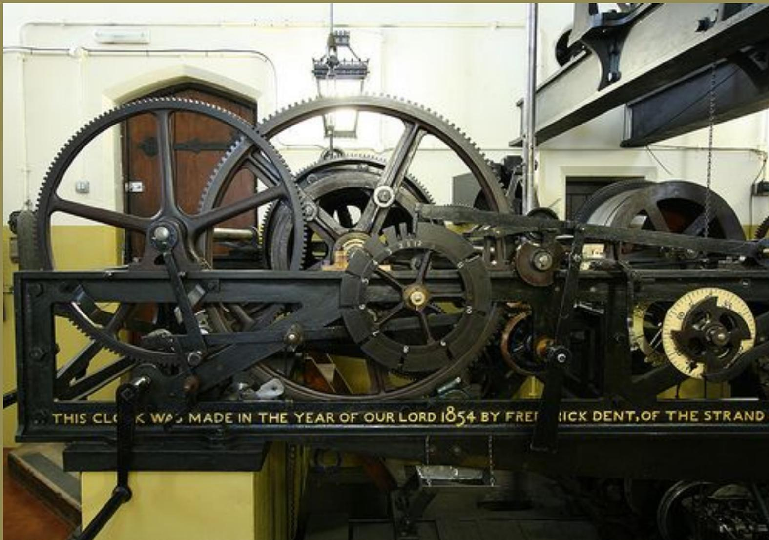
Механизм, приводящий в действие молот колокола Биг-Бен.
