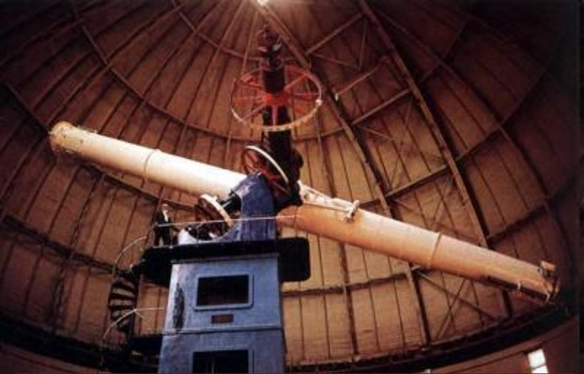
Самый большой рефрактор в мире, который находится в Йеркской обсерватории в США, имеет линзу диаметром в 1 м. Линза с большим диаметром была бы слишком тяжела и сложна в изготовлении.
