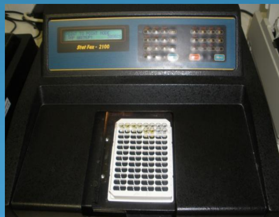
Stat Fax 2100 измеряет оптическую плотность раствора.
