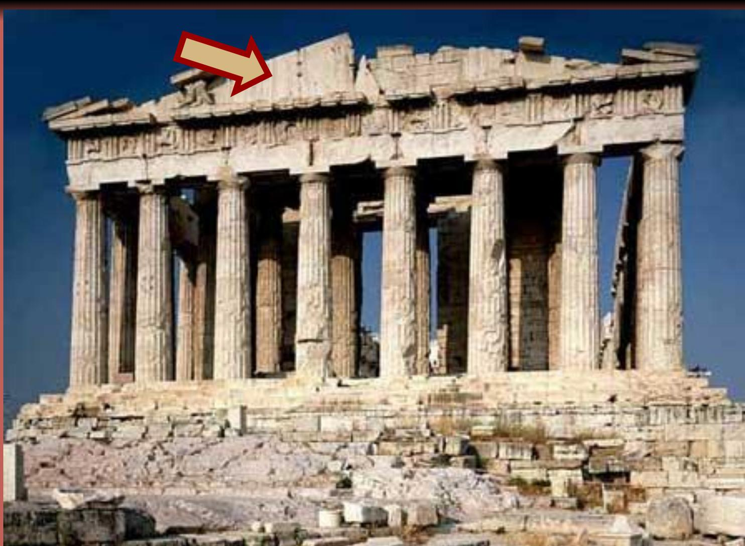
Фронтон - треугольное пространство между двумя скатами крыши и карнизом.
