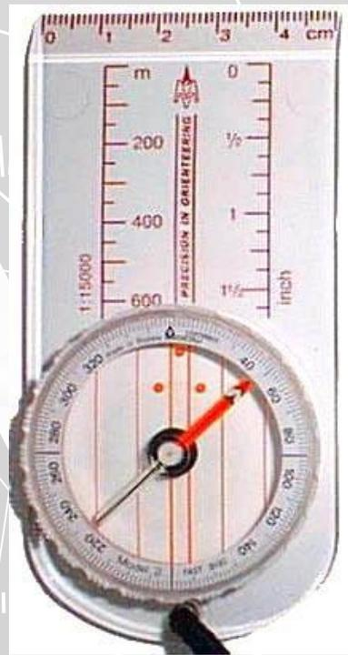
Основным отличием спортивного компаса от обычного (Андрианова) является, то, что стрелка такого компаса помещается в капсуле, наполненной специальной жидкостью, позволяющей стрелке устанавливаться в направлении на север в течение нескольких секунд. Лимб спортивного компаса имеет более точную цену деления – 2 градуса. Капсула расположена на плате компаса, которая имеет измерительную линейку. На капсуле и на плате компаса нанесены параллельные линии, которые облегчают работу с картой.
